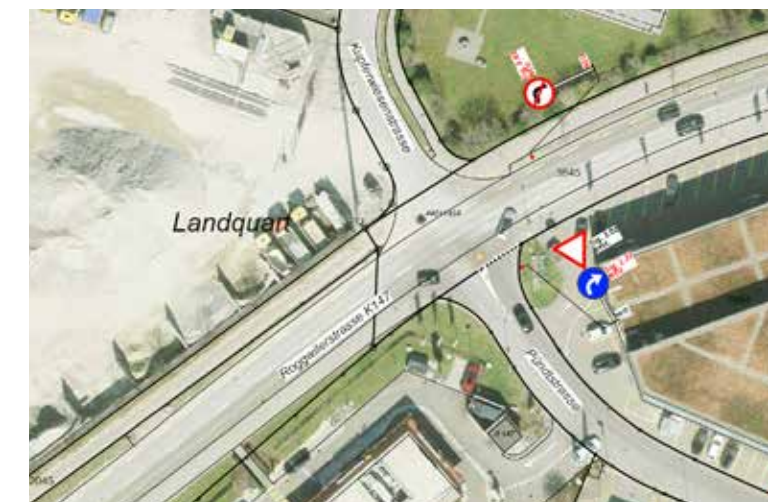
Die geplante neue Signalisation am Knoten Roggwiler-/Pündtstrasse: Neu soll von der Pündtstrasse her nur noch nach rechts abgebogen werden dürfen.
