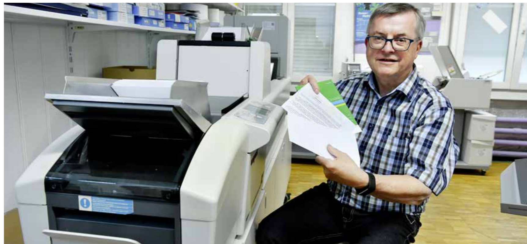
Die neueste Errungenschaft in der Druckerei von Erwin Steiner: Eine Couvertiermaschine, die innert einer Stunde 4500 Umschläge befüllen kann. (Bild: Thomas Peter)
